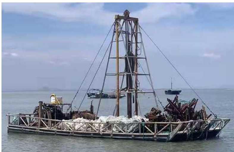
图 2.5-1 施工船（主机功率 220.6kw）
